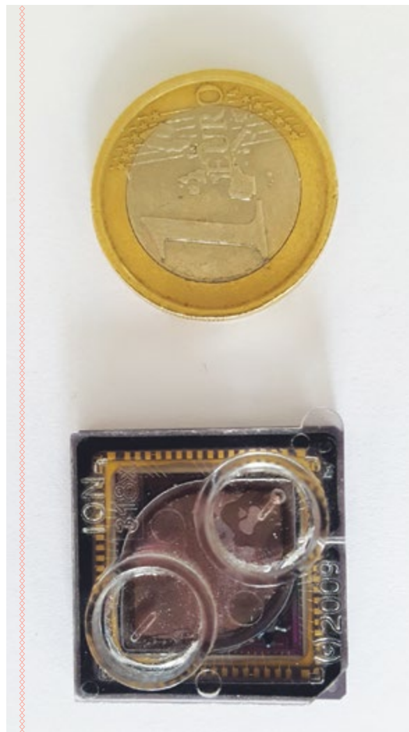
Chip Ion Torrent su cui avviene la reazione di next generation sequencing con le sue dimensioni derivate dalla moneta
